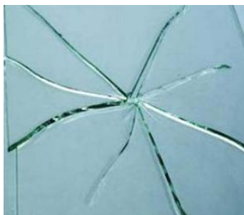
Осколки закаленного стекла Осколки сырого стекла
