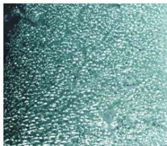
Осколки закаленного стекла Осколки сырого стекла
